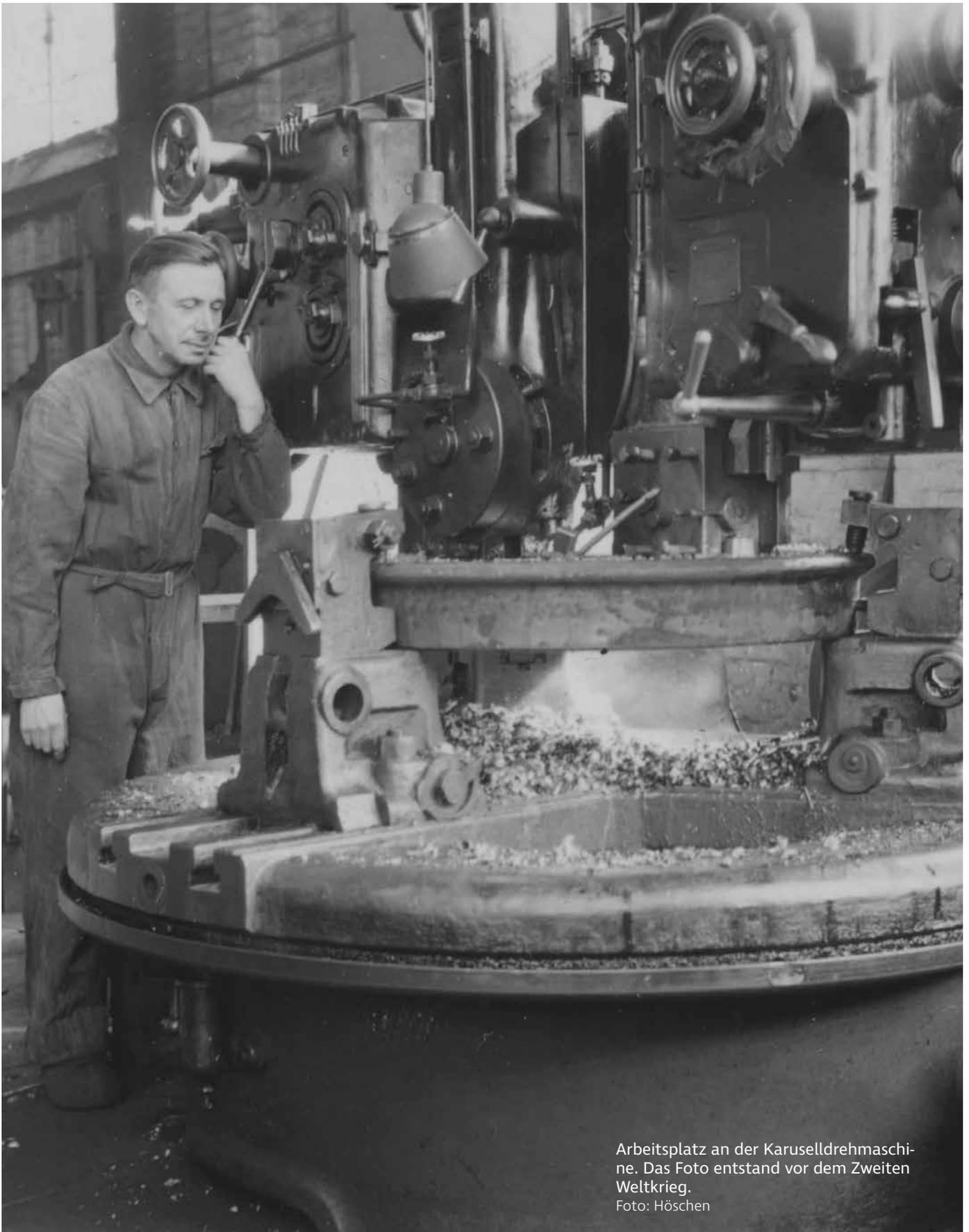
Arbeitsplatz an der Karusellrehmaschine. Das Foto entstand vor dem Zweiten Weltkrieg.
